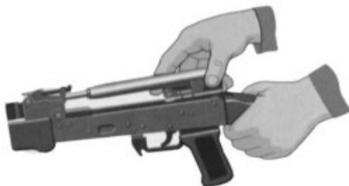
Рисунок 9 – Отделение затворной рамы с затвором
