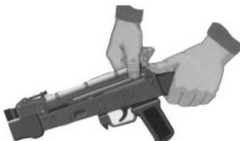
Рисунок 7 – Отделение крышки ствольной коробки
