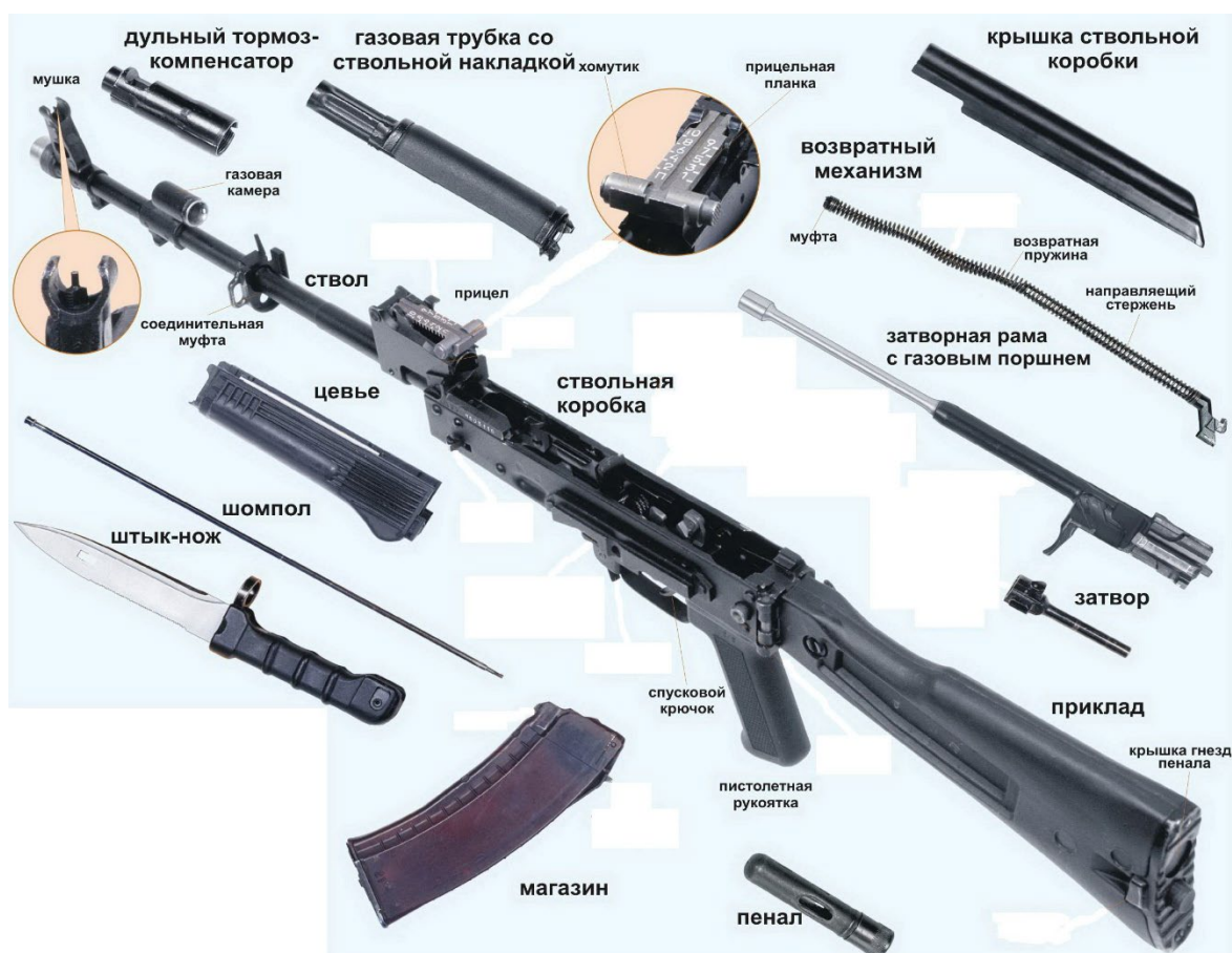
Рисунок 3 – Состав автомата Калашникова АК-74
