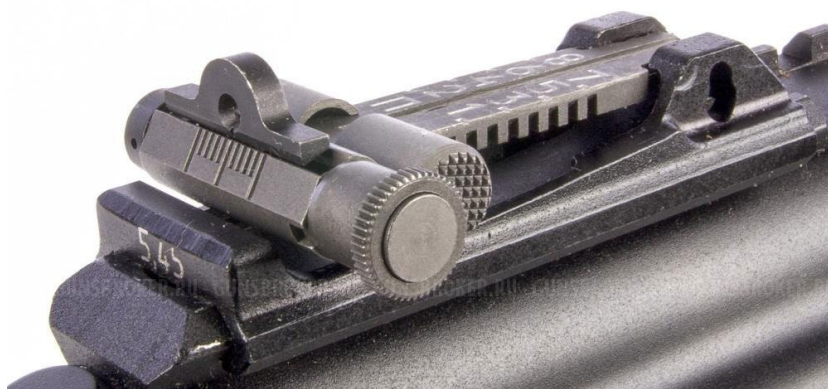
Рисунок 6 – Диоптрический прицел автомата АК-12
